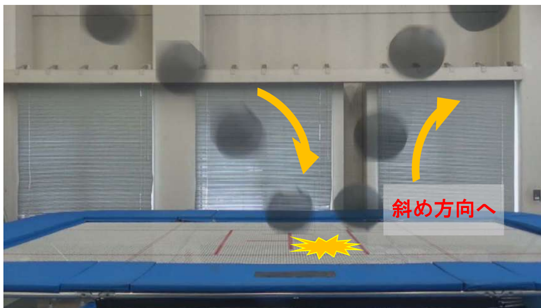
写真4 斜め方向から落下させたときの跳ね返りの様子 ※連続写真を貼り合わせたもの
